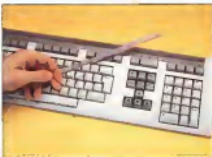
La tastiera del Rainbow 100 è una tra le più avanzate in circolazione, come può essere visto da questa immagine. Una speciale tecnica di assemblaggio rende ogni singola digitazione capace di rivelare al computer la direzione del movimento.
